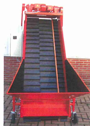
Ruime berubberde Instortbak Eindloze rubberband Met 50 mm hoge meenemers om-en-om
