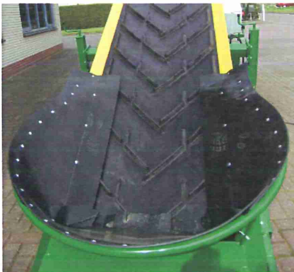
Duurzame rubberband met chevronprofiel (16 of 32 mm) en ronde rubber instortbak
