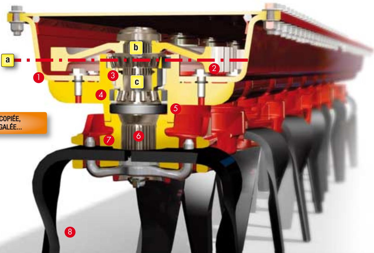
**1 Poutre de grande rigidité, entretien nul :** le caisson profilé d'une épaisseur de 8 mm réalisé en acier à haute limite élastique confère une excellente rigidité à la herse. La lubrification à vie par graisse semi-fluide ne nécessite aucun entretien.
