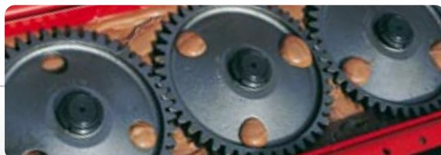
De rotoren worden aangedreven door tandwielen met een grote diameter. De krachtoverbrenging naar de rotoren is gegarandeerd door dat veel tanden tegelijk in elkaar grijpen. Het unieke aandrijfconcept van de KUHN – rotorkopeggen heeft er ongetwijfeld toe bijgedragen dat de wereldwijd door hun betrouwbaarheid geroemde rotorkopeggen reeds meer dan 30 jaar met veel succes worden ingezet.
