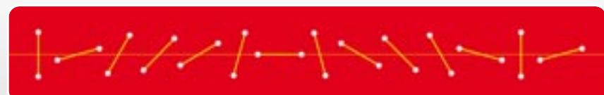
Hierdoor wordt een gelijkmatige bewerking van de grond gegarandeert, dit voorkomt tevens trillingen in de machine en zorgt ervoor dat de vermogensbehoefte gereduceerd wordt.
